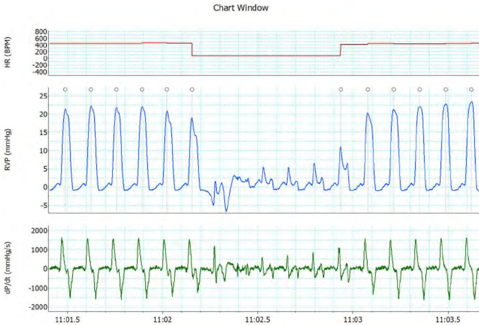
Abb. 3a: Transjuguläre Rechtsherzkatheterisierung (closed chest, FVB Maus, Wildtyp, Körpergewicht 25g). A. Druckkurve über 1.4F Millar-Katheter, plaziert im rechten Ventrikel (RV-Druck = RVP, blaue Kurve), anschliessend Rückzug (pullback) in den rechten Vorhof (RA), und erneutes Vorschieben in den RV. Rote Linie, Herzfrequenz in Schläge pro Minute. Grüne Aufzeichnung, RVdP/dt, d.h. RV-Druckentwicklung über Zeitintervall in mmHg/s.
