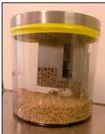
Abb. 3: Hannover "Gnotocage" - der Käfigdeckel beinhaltet HEPA-Filterwatte und kann für den Transport keimfreier Tiere oder kurzzeitige gnotobiotische Experimente verwendet werden.
