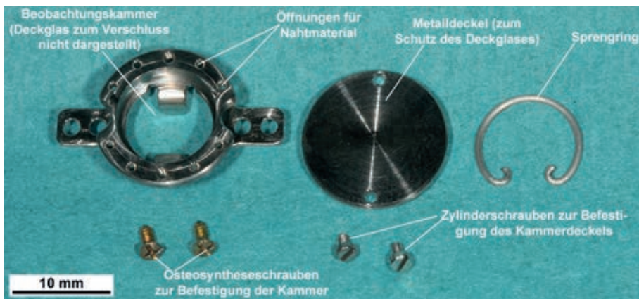
Abb. 1: Bestandteile der Beobachtungskammer am Rattenfemur, die Kammer wird mit Osteosyntheseschrauben, über die zugehörigen Bohrungen, mit dem Femur verschraubt. Dadurch ist die Kammer lagestabil über dem Defekt platziert und dient gleichzeitig zur laststabilen Fixierung des Defektes. Verschlössen wird die Kammer durch ein Deckglas (in der Abbildung nicht dargestellt), welches mit einem Sprengring gesichert wird. Der Metalldeckel dient zum Schutz des Deckglases und verhindert Manipulationen der Tiere an der Kammer.
