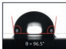
Abb. 2: Kontaktwinkelmessung mit einem Wassertropfen auf Titan SLIPS. Der gemessene Winkel von 96,5^\circ weist die Oberfläche als hydrophob aus.
