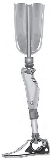
Abb. 1: Skizze einer knochenverankerten, transkutan ausgeleiteten Extremitätenprothese
